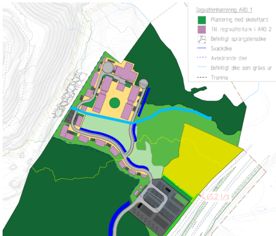
Figur 14. Inzoomning på ARO 2 med föreslagna dagvattenåtgärder
